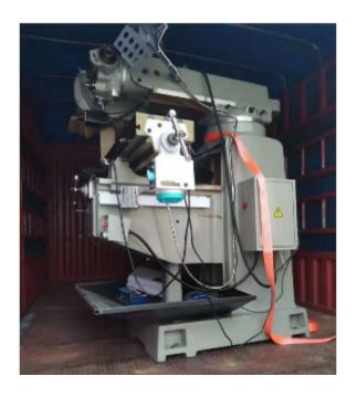
炮塔铣床的使用方法注意:应用走刀器走刀时,务必调好行程安排,严禁迅速换相返向生产加工导致传动齿轮打烂。操作台严禁夹装超负荷工件,(限定100KG)特殊情况务必经经理愿意后才能应用。铣床路轨维护伸缩式橡胶板务必完整无缺,那样才可以具有挡屑功效。应用铣床脚踏式高低速档换相时,务必保证传动齿轮早已挂及时,用人力资源传动系统无有响时方可开电工作中。所有人用完机床后,务必清扫整洁和再加防锈剂。炮塔铣床日常事务中应当注意的事项:炮塔铣床运作中出現异常情况,应该马上关机,查清缘故,并妥善处理。
