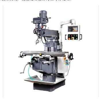
铣床的保养: 1、清洁: 拆卸清洗各部刮油皮; 擦拭各滑动面和导轨面、擦拭工作台及横向、升降丝杆、擦
