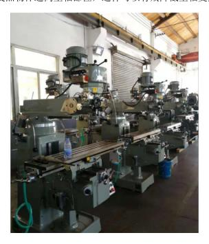
炮塔铣床的行程是多大?炮塔铣床是一种轻型通用金属切削机床,具有立、卧铣两种功能,可铣削中、小零件的平面、斜面、沟槽和花键等。摇臂铣床:摇臂铣床亦可称为炮塔铣床,摇臂铣,工作台较常见的工作台面是1270\*254mm,较大的是工作台面1370\*330mm□左右行程在从760-1000mm.前后行程380mm.上下行程在400到480mm之间,如果超出此范围太远的铣床就不是炮塔铣床了。而是其它铣床的种类了。悬臂式铣床:铣头装在悬臂上的铣床,床身水平布置,悬臂一般可沿床身一侧立柱导轨作垂直移动,铣头沿悬臂导轨移动。升降台铣床:具有可沿床身导轨垂直移动的升降台的铣床,通常安装在升降台上的工作台和滑鞍可分别作纵向、横向移动。身式铣床:工作台不能升降,可沿床座导轨作纵向、横向移动,铣头或立柱可作垂直移动的铣床。不同的铣床工作台台面和加工范围用途是不一样的。湖南小型炮塔铣床多少钱高速和低速倒车应与离合器手柄一起使用。
